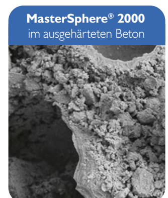
Verbleibende Mikroluftpore mit ausgetrocknetem SAP-Partikel
