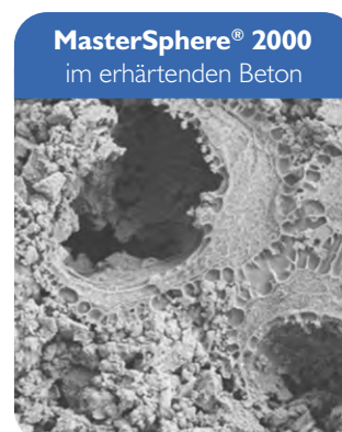
Wasserabgabe in die Zementmatrix und Bildung der luftgefüllten Mikropore
